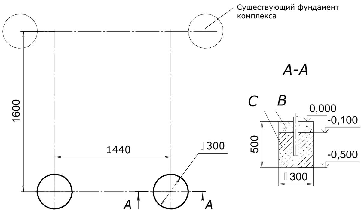
Для исключения люфтов при занятиях на изделии рекомендуется при монтаже максимально распереть стойки, зафиксировать их в таком положении при помощи подручного материала (кирпичи, доски и т.п.), после этого забетонировать.
